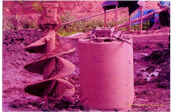
Foto 2 - Dua jenis mata bor yang akan digunakan untuk pemboran lubang dinding halang (diaphragm wall)
